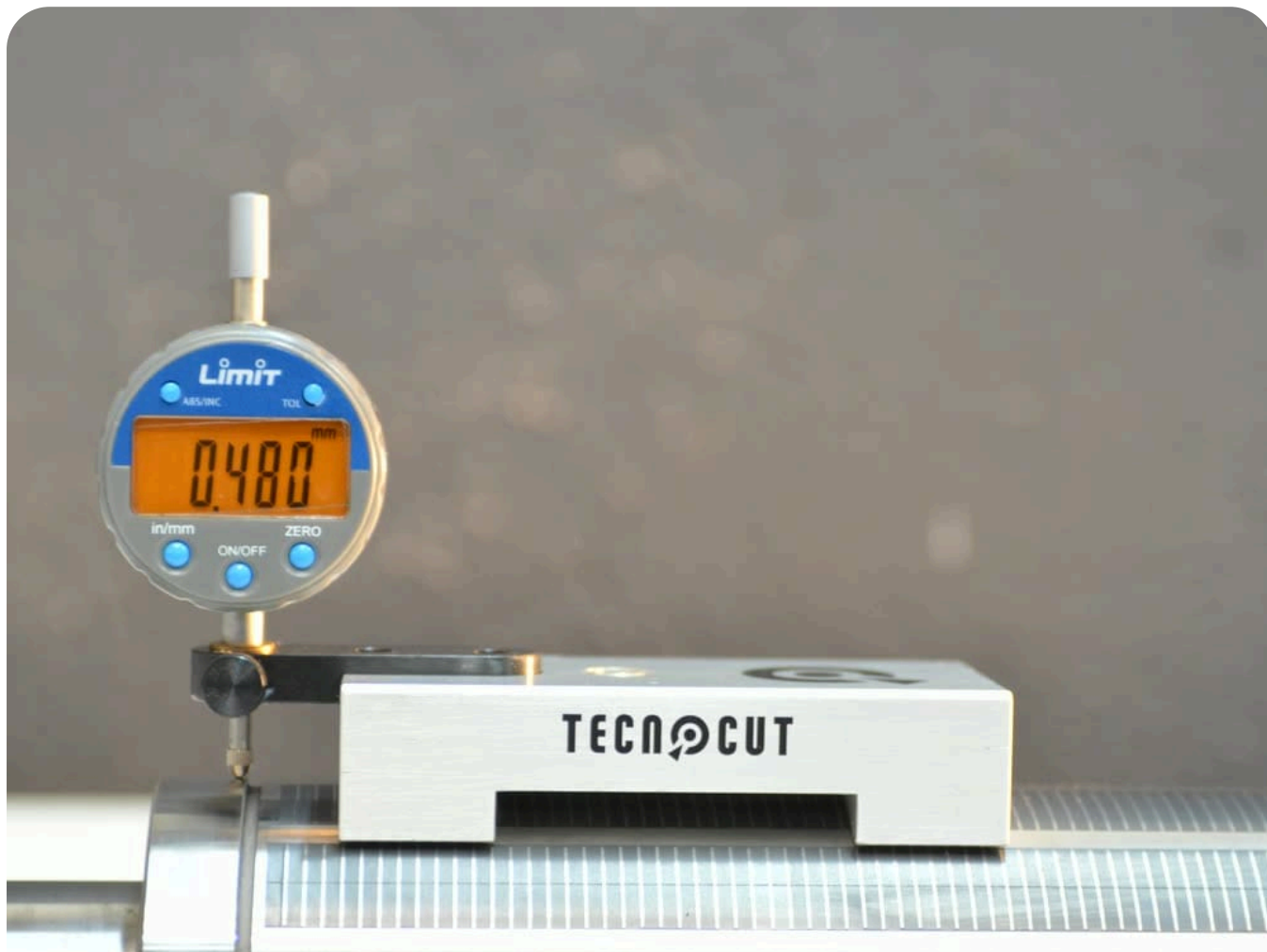
LECTURE DIRECTE SUR LA BAGUE D'APPUI
